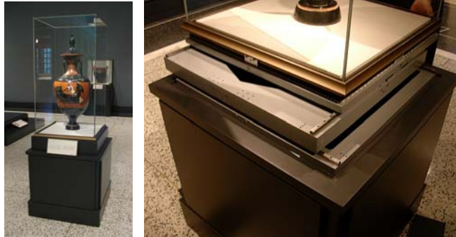
Koumouisis图1 在Getty博物馆的一个展品下安装了一个小型减震隔离装置。右图所示的是保护板拿开后展现出来的隔离体。
