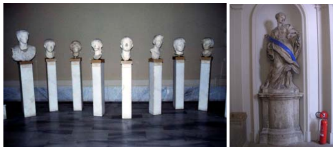
Podany Abb. 2: In Museen rund um den Globus finden sich Sammlungen, die von Schäden durch Erdbeben bedroht sind. Instabile Anordnungen und Befestigungen, wie hier links zu sehen, sind häufig zu finden. Es gibt einfache und relativ günstige Lösungen, die aber auch elegant und diskret sein müssen, wenn sie nachhaltig und für den musealen Bereich akzeptabel sein sollen. Das Beispiel rechts schützt das Objekt mit Sicherheit gut, stört aber den Anblick und macht künftige Bemühungen um Erbebensicherheit nur noch schwieriger. (Fotos: J. Podany)
