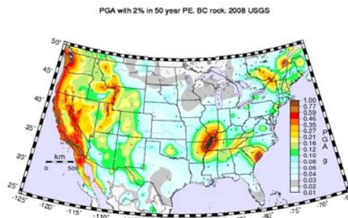
PGA with 2% in 50 year PE, BC rock, 2008 USGS Somerville Abb. 3: Karte der Spitzenbeschleunigung auf weichem Gestein in den Vereinigten Staaten mit einer 2%igen Überschreitungswahrscheinlichkeit binnen 50 Jahren. Konstruktions-Erdbebenwerten in den Vereinigten Staaten sind üblicherweise 2/3 dieser Werte. Quelle: http://earthquake.usgs.gov/research/hazmaps/
